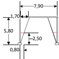
Ограничение строительства по высоте. Колонны отмечены красным.
